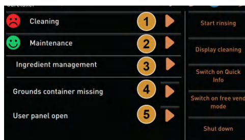
Fig.: Servicemenu med status vedligeholdelse og fejl
