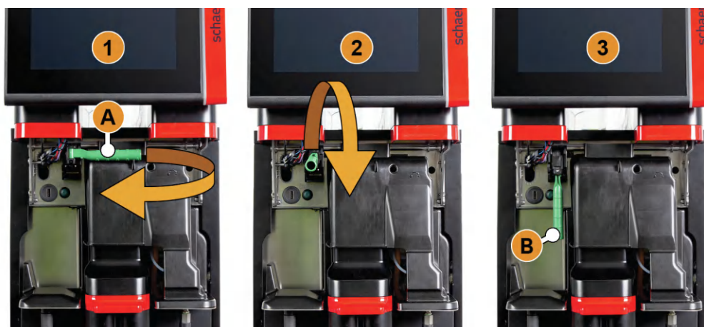
Fig.: Oplåsning af bønnebeholder og pulverbeholder (ekstraudstyr)
